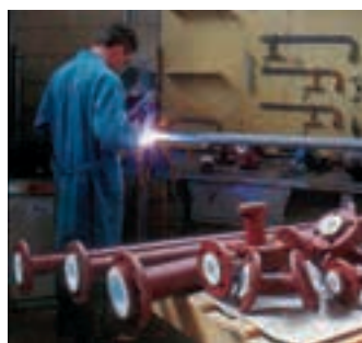
Reparto saldatura raccordi acciaio + PTFE (Cividate)
