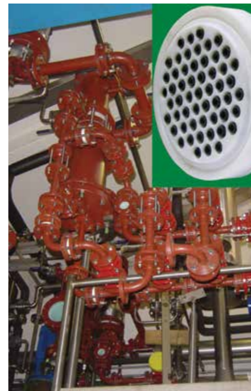
Tubi PTFE lined su colonna sviluppo vapori di un reattore
