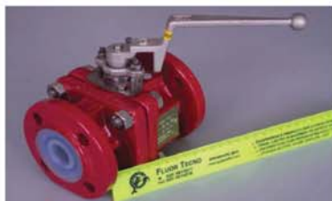
Valvole a sfera tipo KN in Ghisa rivestita TEFLON PFA con sfera ceramica AI203 o PFA (resistente all'abrasione)
